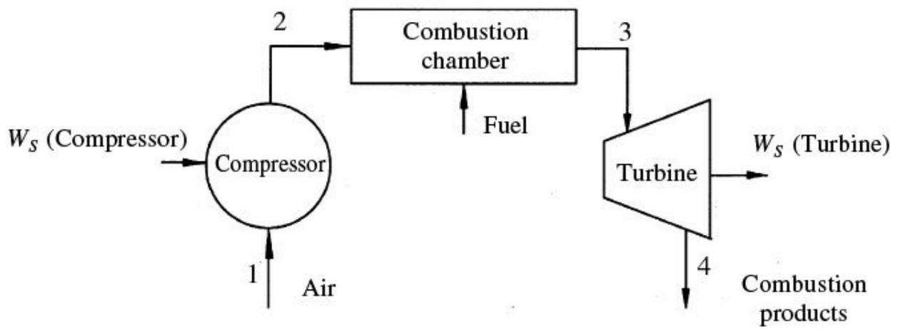
**Fig. 5.27(a)** The open cycle gas-turbine power plant.
