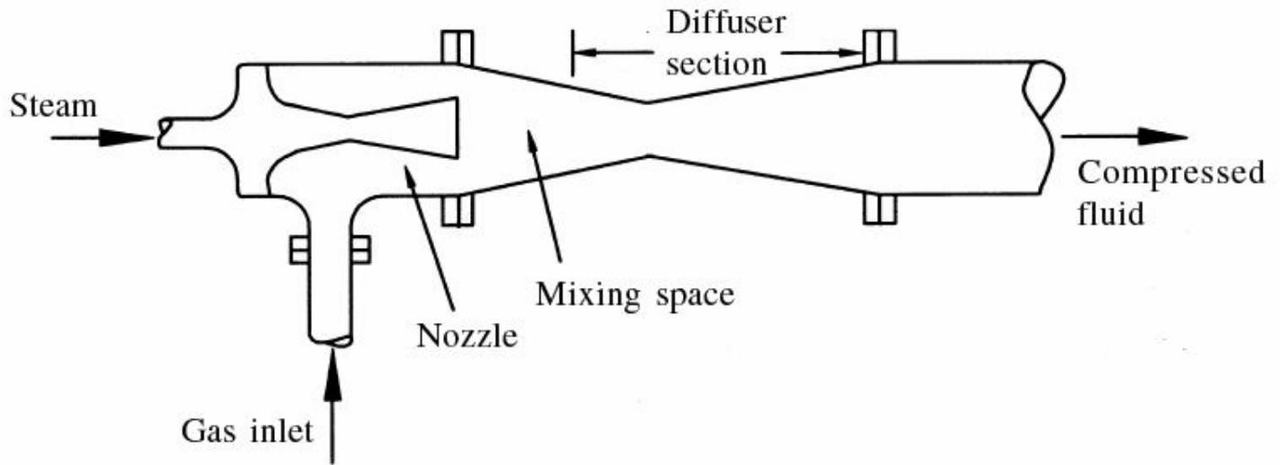
**Fig. 5.3** Steam-jet ejector.
